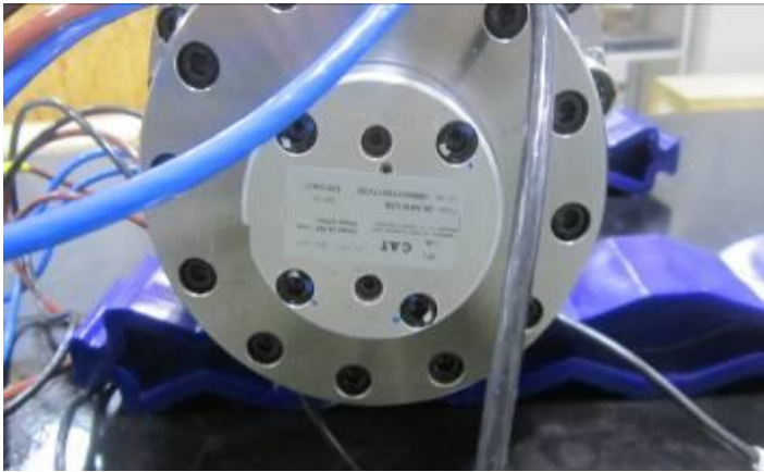
Bild 4.2: Makroaufnahme der Drehdurchführung / extreme close-up rotary of the transmission leadthrough / giunto rotante
