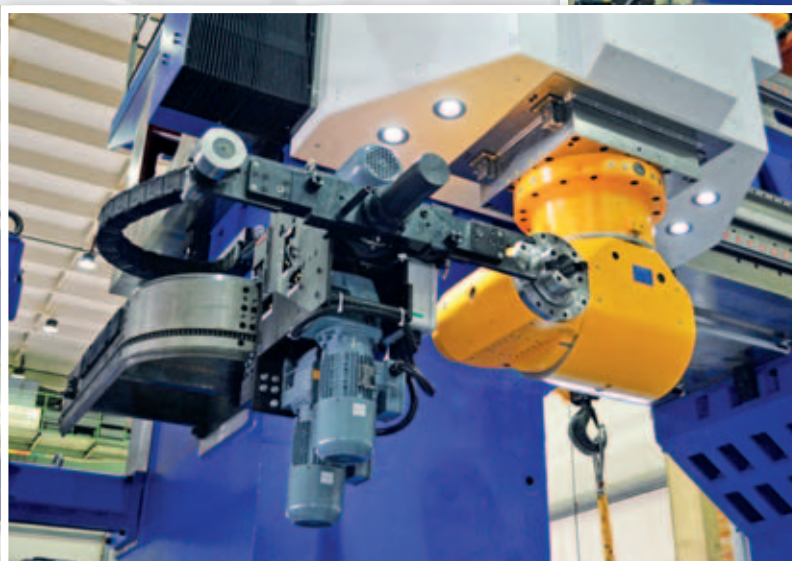
Деталь автоматической системы замены инструмента, которая меняет инструмент в горизонтально расположенной фрезерной головке.
