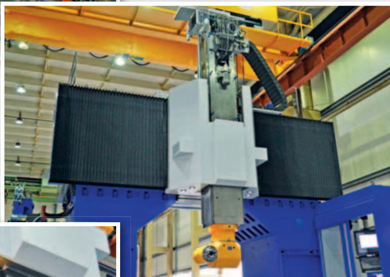
Общий вид станка с горизонтально перемещаемой передней бабкой и вертикально выдвигаемым ползуном.
